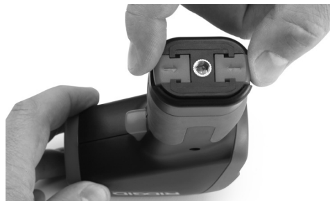
Рис. 4 – Извлечение держателя батарейки
